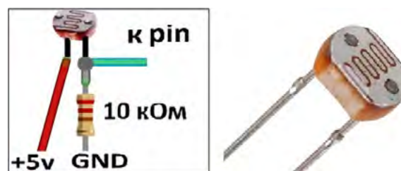
Рис. 4. Схема подключения фоторезистора к Ардуино
