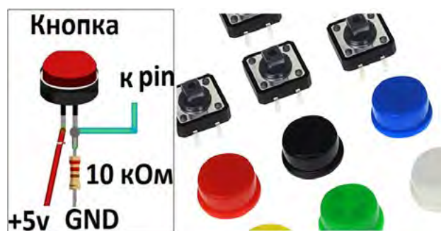
Рис. 1. Схема подключения тактовой кнопки к микроконтроллерной плате
